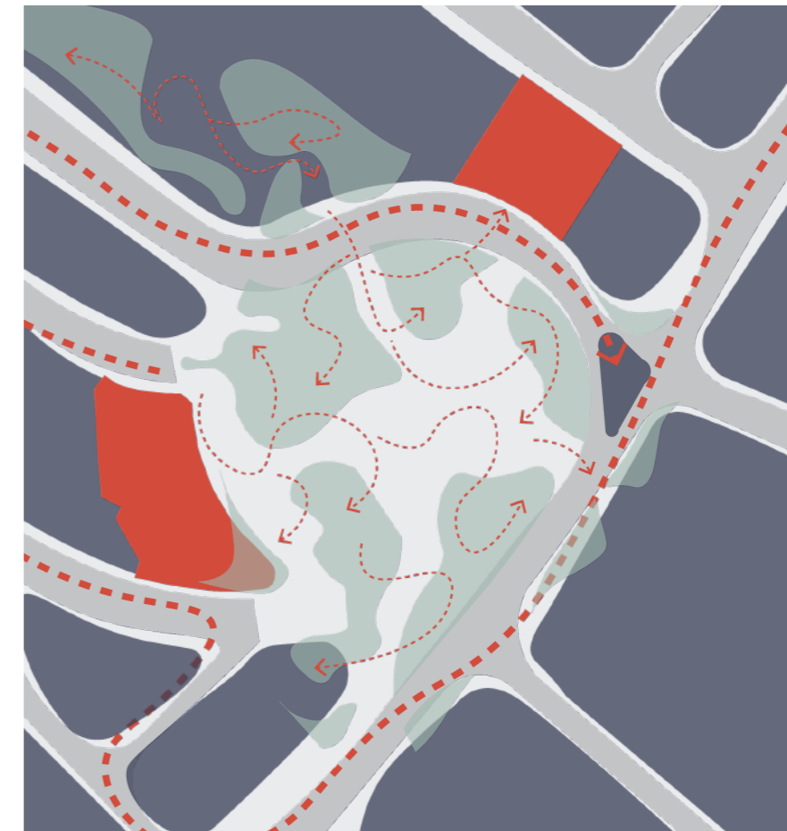
situação proposta de fluxo de pedestres e carros, com redesenho do redondão e ampliação das calçadas
