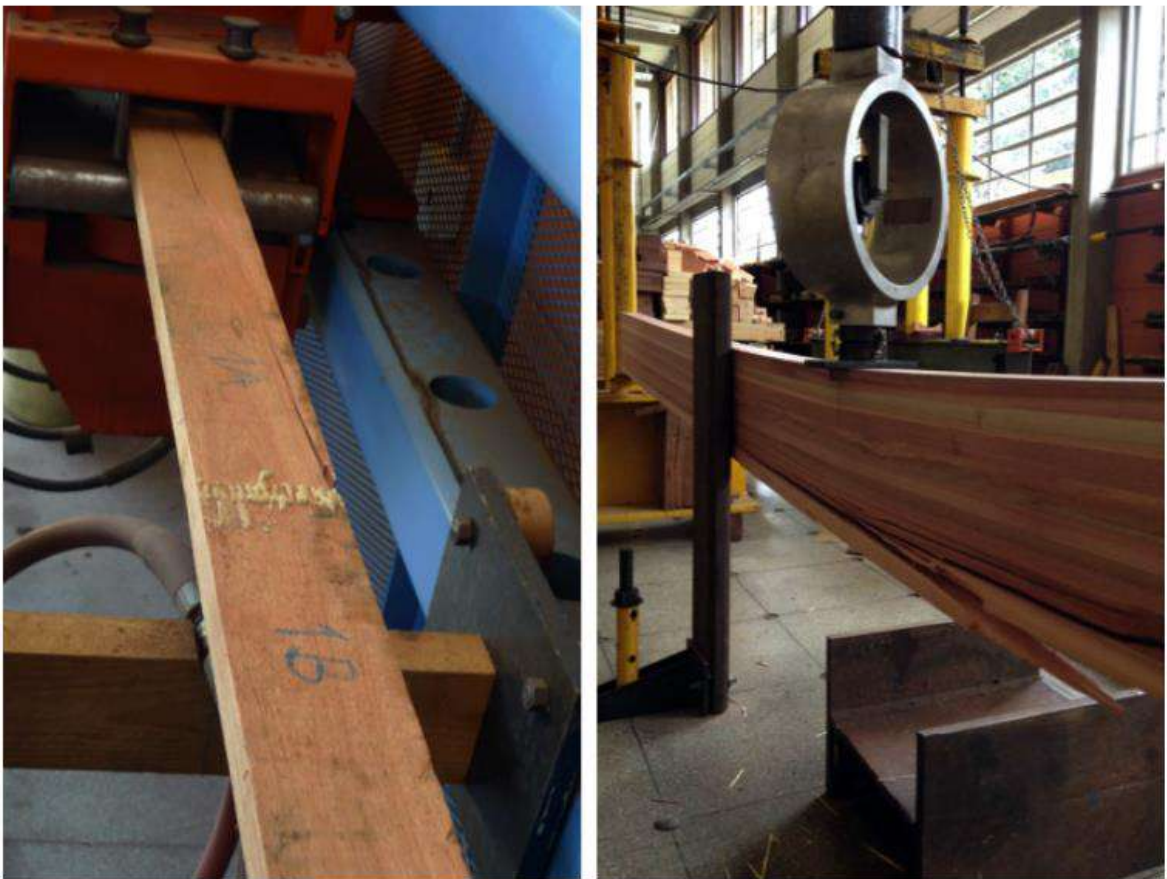
Ensaio técnico de tração no finger e ruptura de vigas; Universidade de São Paulo, São Carlos
